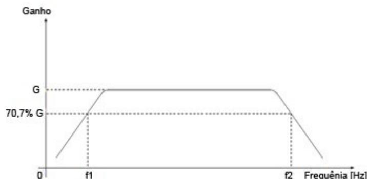
**Figura 2.11 - Resposta em frequência de amplificador de biopotencial**
