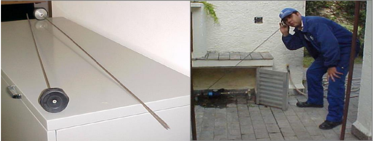
Figura 11 – Haste de escuta e sua utilização.
