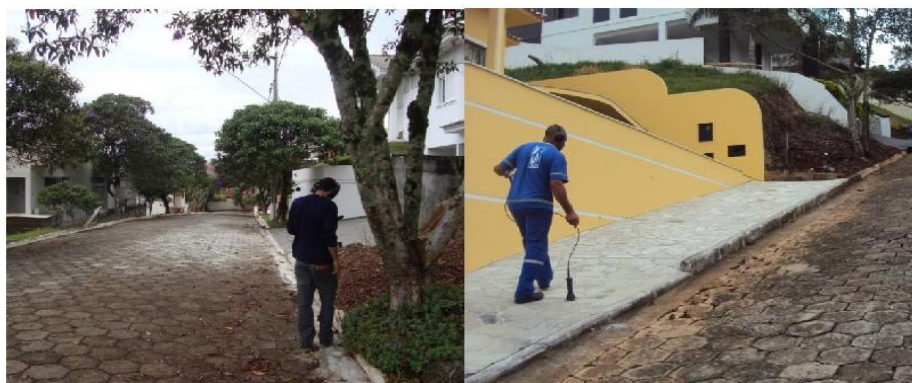
Figura 72 – Passagem do geofone na rua Alameda A do bairro Moradas da Serra.
