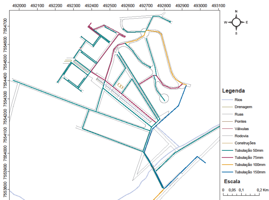
Figura 36 – Layout da rede de distribuição dos bairros Vale dos pinheiros e Moradas da Serra.
