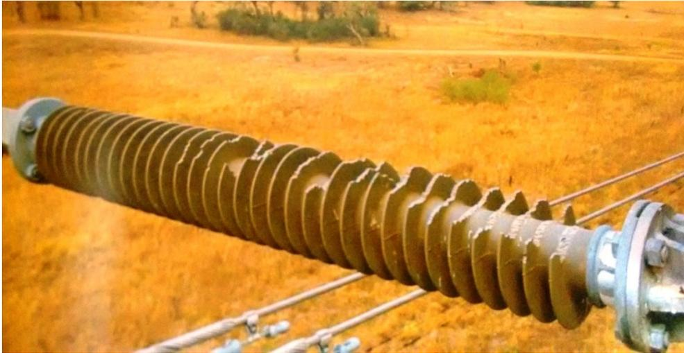
**Figura 1.4 – Danificação de isoladores poliméricos de SiR por ataque de pássaros. Fonte: (ZIMMERMAN, 2013).**
