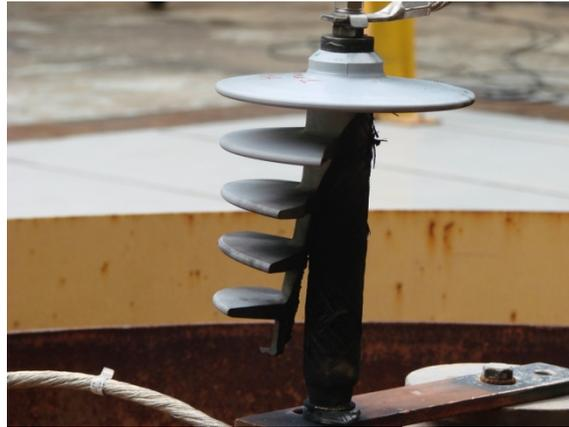
Figura 3.7 – Estrutura do para-raios após o ensaio de curto-circuito de 3 kA. Fonte: CEPEL.
