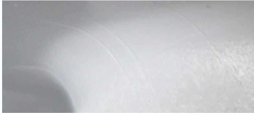
**Figura 4.5 – Detalhe das pequenas trincas observadas entre as junções das saias e do corpo do para-raios.**
