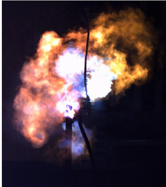
Figura 5.10 – Detalhe do arco elétrico formado durante o ensaio de curto-circuito de 16 kA, 200 ms.
