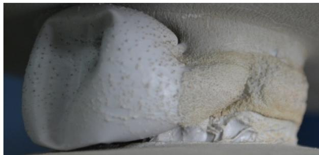
**Figura 4.16 – Bolha formada após a falha do segundo protótipo de para-raios, formulação 5.**
