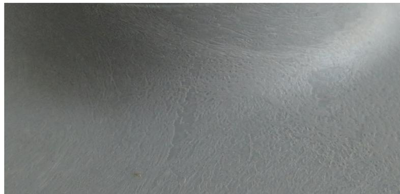
**Figura 4.4 – Vista superior da saia do segundo protótipo de para-raios em PEAD, evidenciando a rugosidade superficial.**
