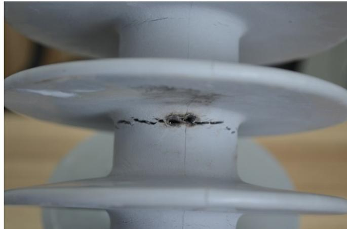
**Figura 3.10 – Falha no invólucro do primeiro protótipo de para-raios de PEAD durante o ensaio de envelhecimento com concentração salina reduzida para  $5 \text{ kg/m}^3$  de sal em água.**
