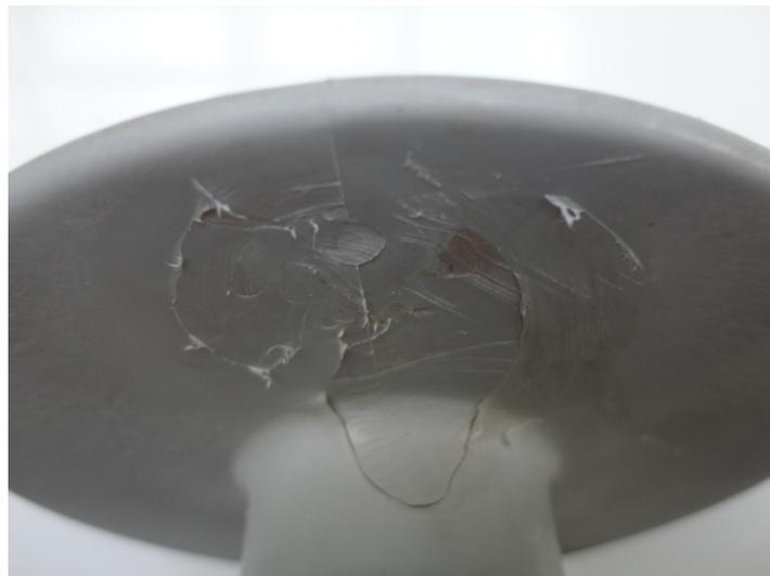
**Figura 4.6 – Delaminação do material polimérico observado para 10% de concentração de aditivo plastificante.**
