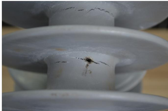
**Figura 3.9 – Falha observada durante a realização do ensaio de envelhecimento em névoa salina no primeiro protótipo de para-raios de PEAD. Perfuração e queima do material polimérico, trincas e acúmulo de sal na parte inferior das saias dos para-raios.**
