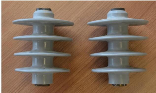
**Figura 5.17 – Unidades do terceiro protótipo de para-raios após o ensaio de imersão em água.**
