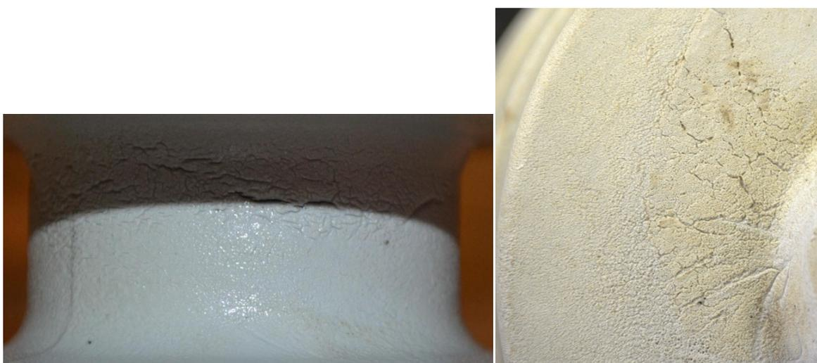
**Figura 4.9 – Exemplo de observações do Tipo 3: Aumento das trincas ao longo do corpo do para-raios.**
