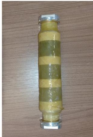
**Figura 3.3 – Exemplo de um módulo dos para-raios de tensão nominal de 15 kV produzido pela PLP e utilizado nesse trabalho.**
