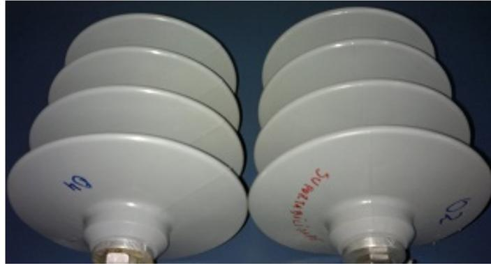
**Figura 3.14 – Amostras após o ensaio de ciclo térmico.**
