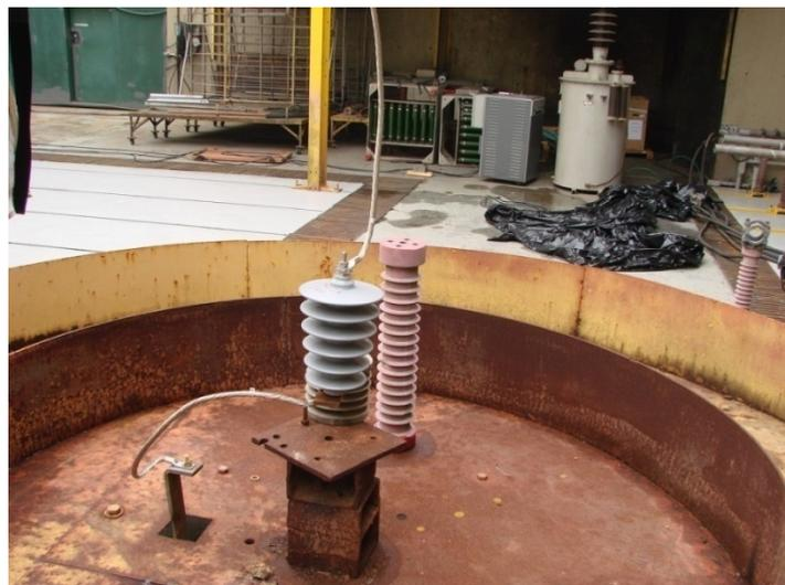
**Figura 3.5 – Montagem do primeiro protótipo de para-raios de PEAD de tensão nominal de 24 kV para o ensaio de curto-circuito. Fonte: CEPEL.**
