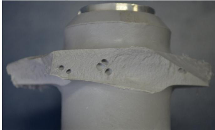
**Figura 4.17 – Detalhe das micro-cavidades existentes ao longo do invólucro do segundo protótipo de para-raios.**
