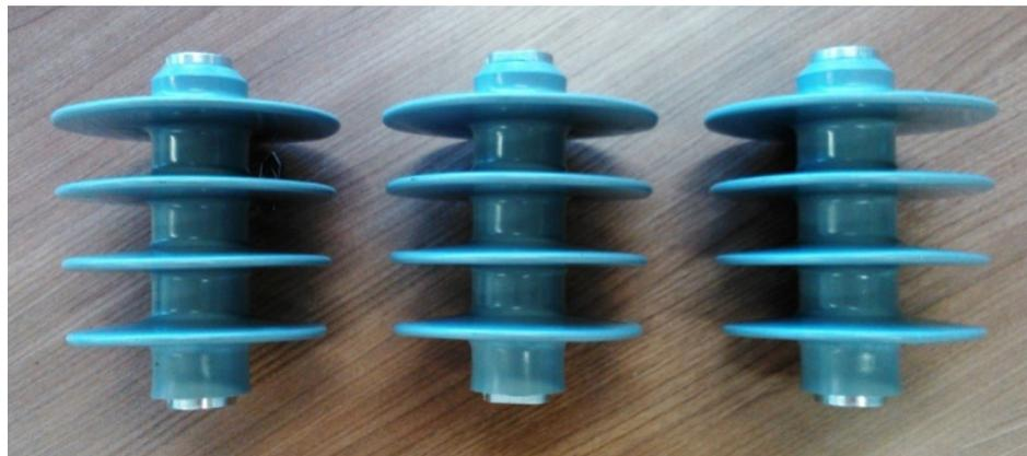
**Figura 5.16 – Unidades do terceiro protótipo de para-raios de PEAD após o ensaio de ciclo de operação.**
