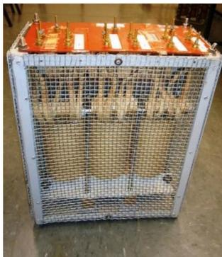
Figura 1: Filtro Eletromagnético de Sequência Positiva e Negativa.
