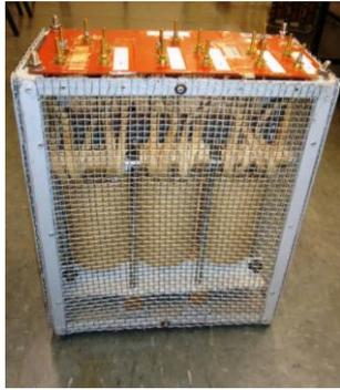
Fig. 1. Filtro Eletromagnético de Sequência Positiva e Negativa.
