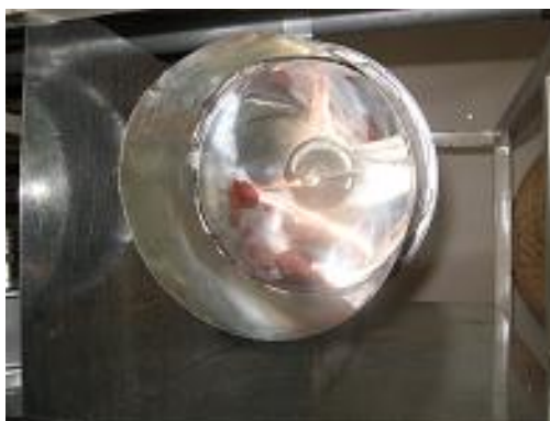
Figura 5.9 – Antena de transmissão com Radome
