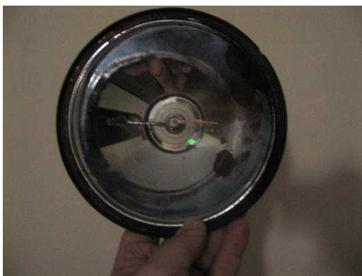
Figura 5.7 – Antena de recepção com dipolo meia onda
