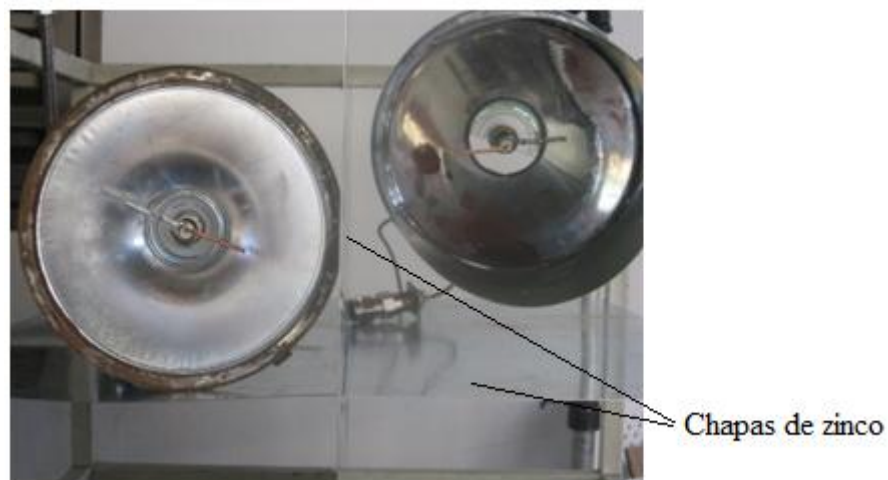
Figura 5.14 – Foto das antenas de transmissão e recepção
