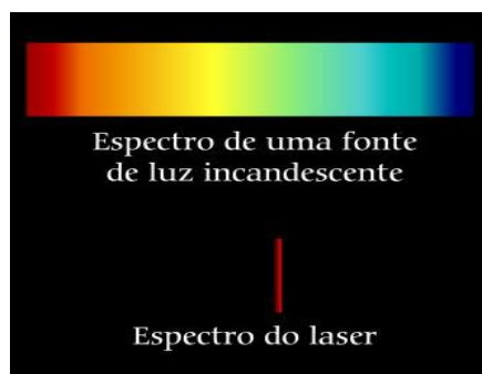
Figura 3.6 – Espectro contínuo e espectro discreto do laser
