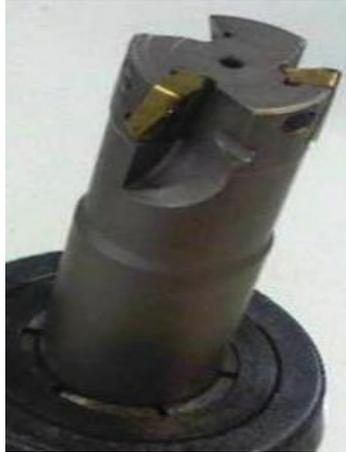
Figura 3.2 – Cabeçote com insertos para o fresamento de topo.
