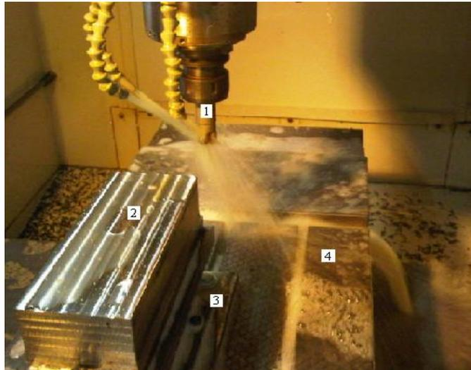
Figura 3.8 – Montagem do corpo de prova. (1) ferramenta; (2) corpo de prova; (3) dispositivo de fixação do corpo de prova; (4) mesa fresadora.
