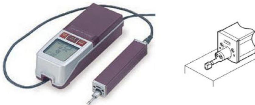
Figura 3.5 – Rugosímetro utilizado no experimento.
