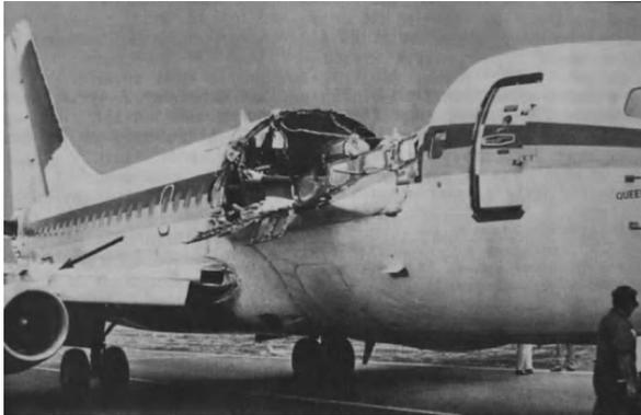
(a) Danos causados por fadiga em torno de rebites da fuselagem (Farrar e Worden (2012))
