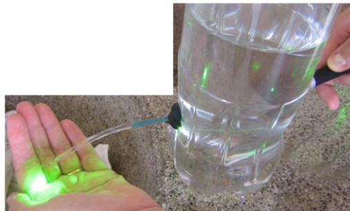
Figura 24 – Utilizando o laser com o filete de água
