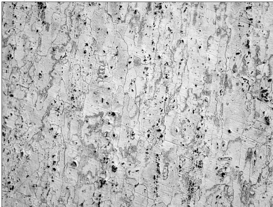
Figura 67- Imagem de MO da liga de Al 7075 solubilizada a 450°C por 4h com redução em área de 25% e envelhecida artificialmente a 120°C por 24h, com ataque químico por reagente Keller, com ampliação de 50x.
