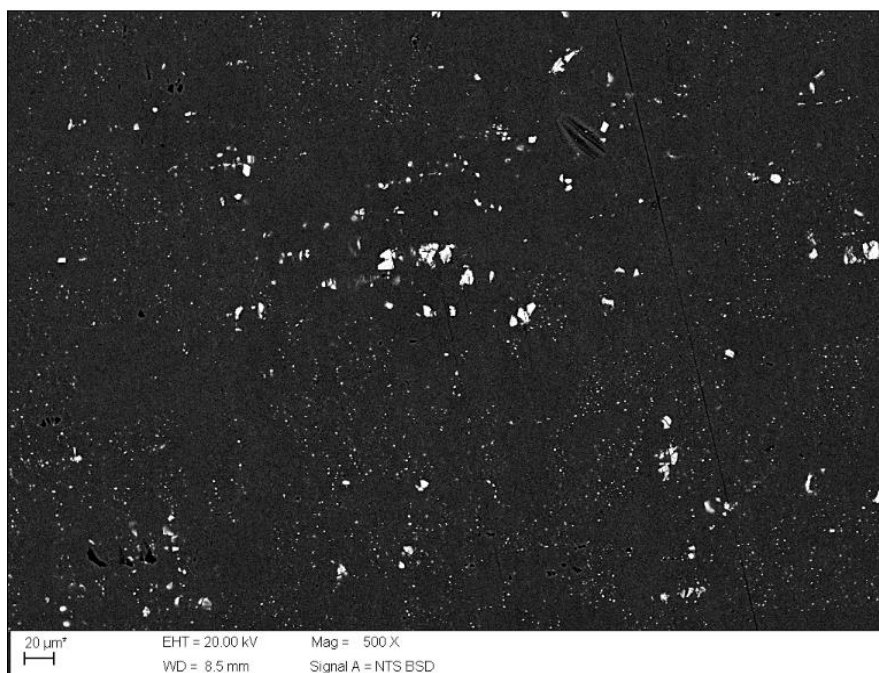
Figura 71- Micrografia obtida por MEV no modo BSD, da direção superficial da amostra de Al 7075-T6 solubilizada a 450°C por 4h, laminada a frio com redução em área de 75% e EA a 120°C por 24h, sem ataque químico.
