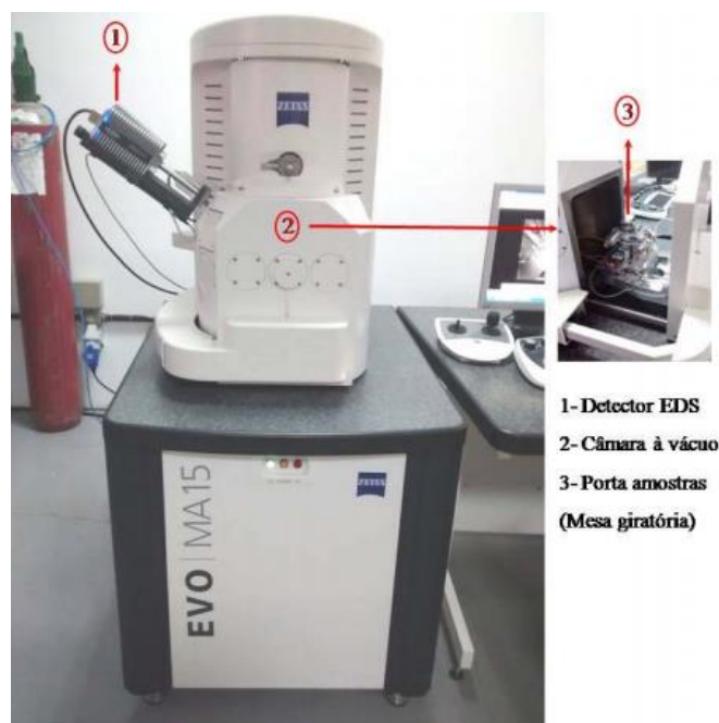
Figura 35 - Microscópio eletrônico de varredura. Marca Zeiss, modelo EVO MA15.
