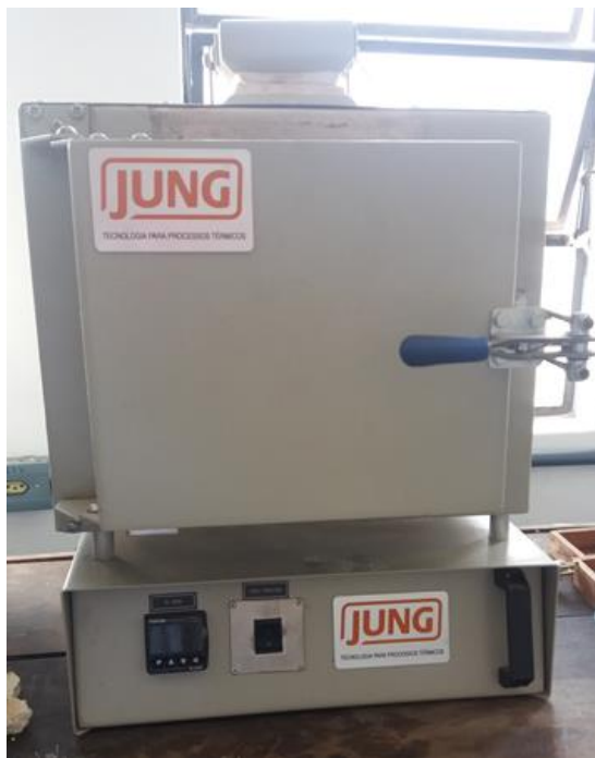
Figura 30 - Forno Jung N1200, utilizado para os tratamentos térmicos, Laboratório de Materiais e Metalurgia - UNIFEI.
