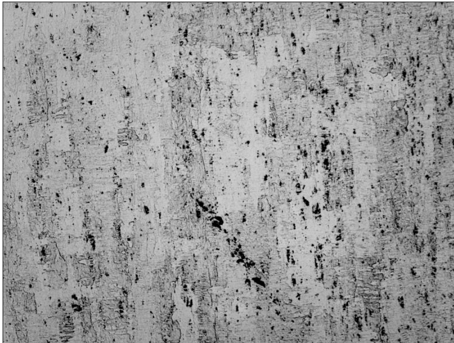
Figura 69 - Imagem de MO da liga de Al 7075 solubilizada a 450°C por 4h com redução em área de 75% e envelhecida artificialmente a 120°C por 24h, com ataque químico por reagente Keller, com ampliação de 50x.
