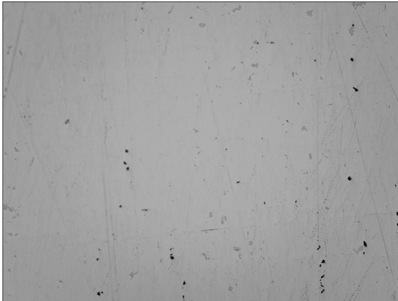
Figura 43- Imagem de microscopia óptica da amostra da liga de Al AA7075 solubilizada (S) sem ataque químico, com ampliação de 100 x.
