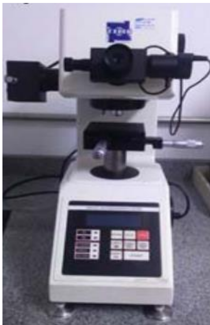
Figura 34 - Microdurômetro Vickers marca Time, modelo TH 712.
