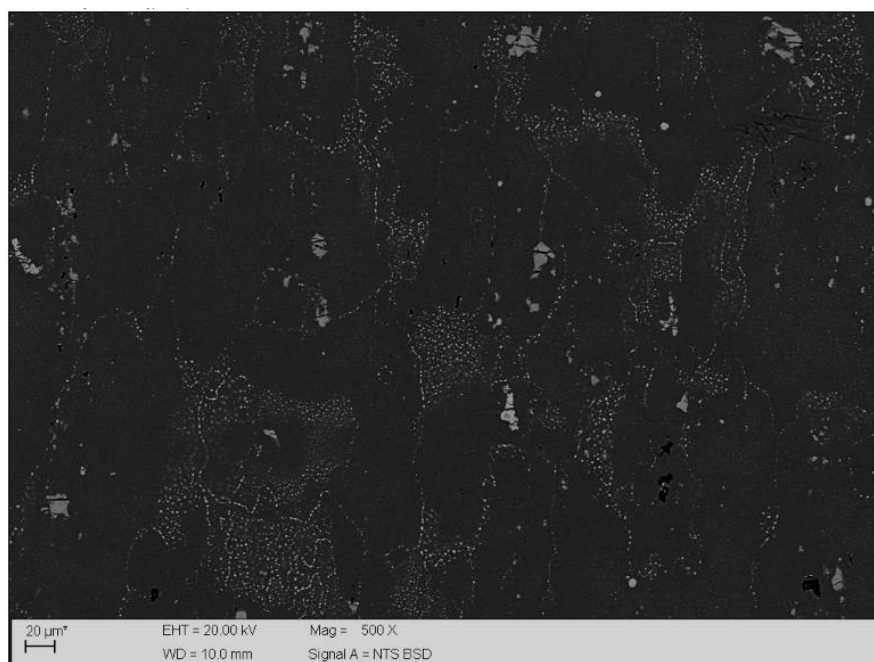
Figura 51- Micrografia obtida por MEV no modo BSD, da direção superficial da amostra de Al 7075-T6 com redução em área de 25%, sem ataque químico.
