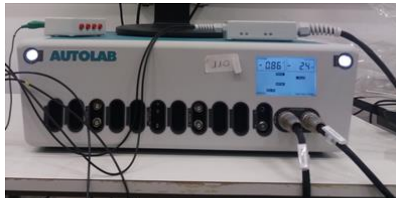
Figura 33- Potenciostato/Galvanostato, PGSTAT 128N AUTOLAB.
