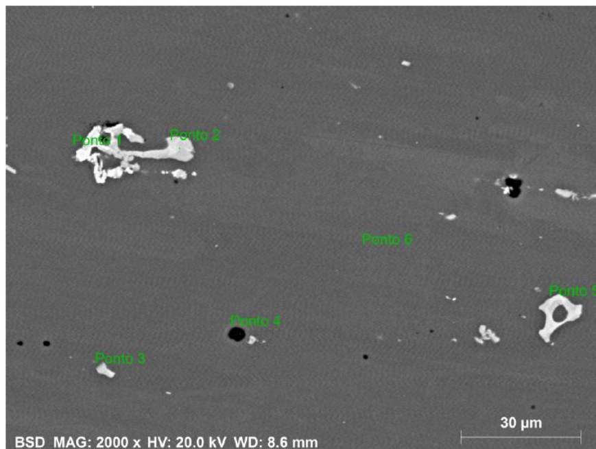
Figura 42 - Morfologia por MEV das fases encontradas na amostra CR AA7075-T6.
