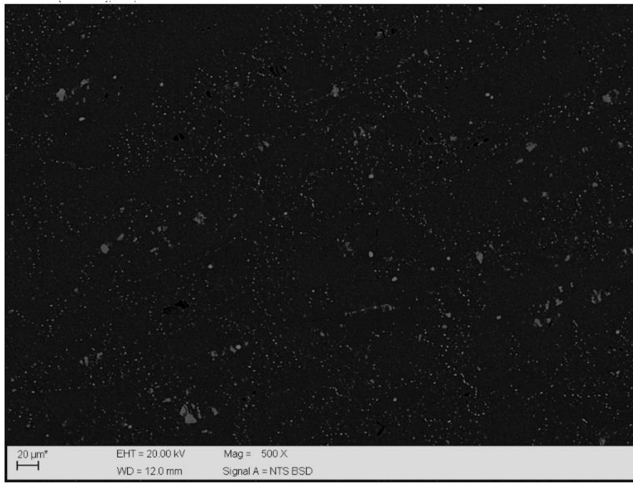
Figura 53-Micrografia obtida por MEV no modo BSD, da direção superficial da amostra de Al 7075-T6 com redução em área de 75%, sem ataque químico.
