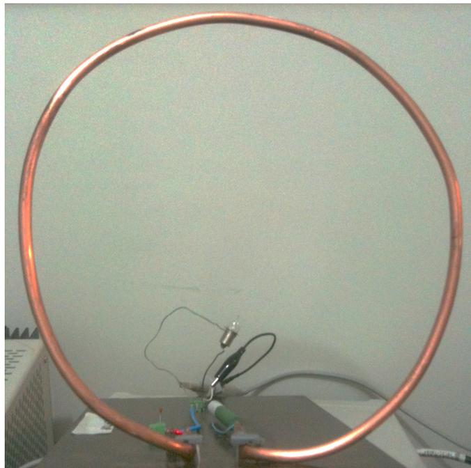
**Figura 4.2** - Antena do receptor confeccionada, tipo espira com um enrolamento, diâmetro de 23 cm e bitola do fio de 6 mm.
