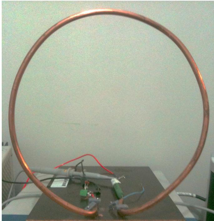
**Figura 4.1** – Antena do transmissor confeccionada, tipo espira com um enrolamento, diâmetro de 23 cm e bitola do fio de 6 mm.
