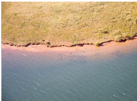
Figura 2.1 – Ação das ondas em margem do reservatório.
