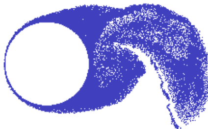
Figura 5.9: Formação da esteira próxima no instante de tempo t=34,90 (Ponto C)
