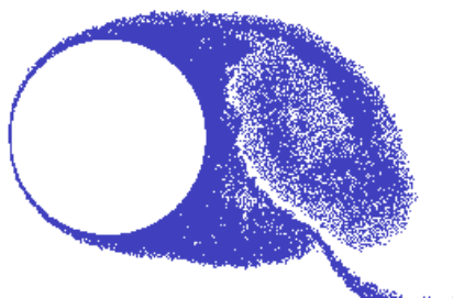
Figura 5.8: Formação da esteira próxima no instante de tempo t=34,00 (Ponto B)
